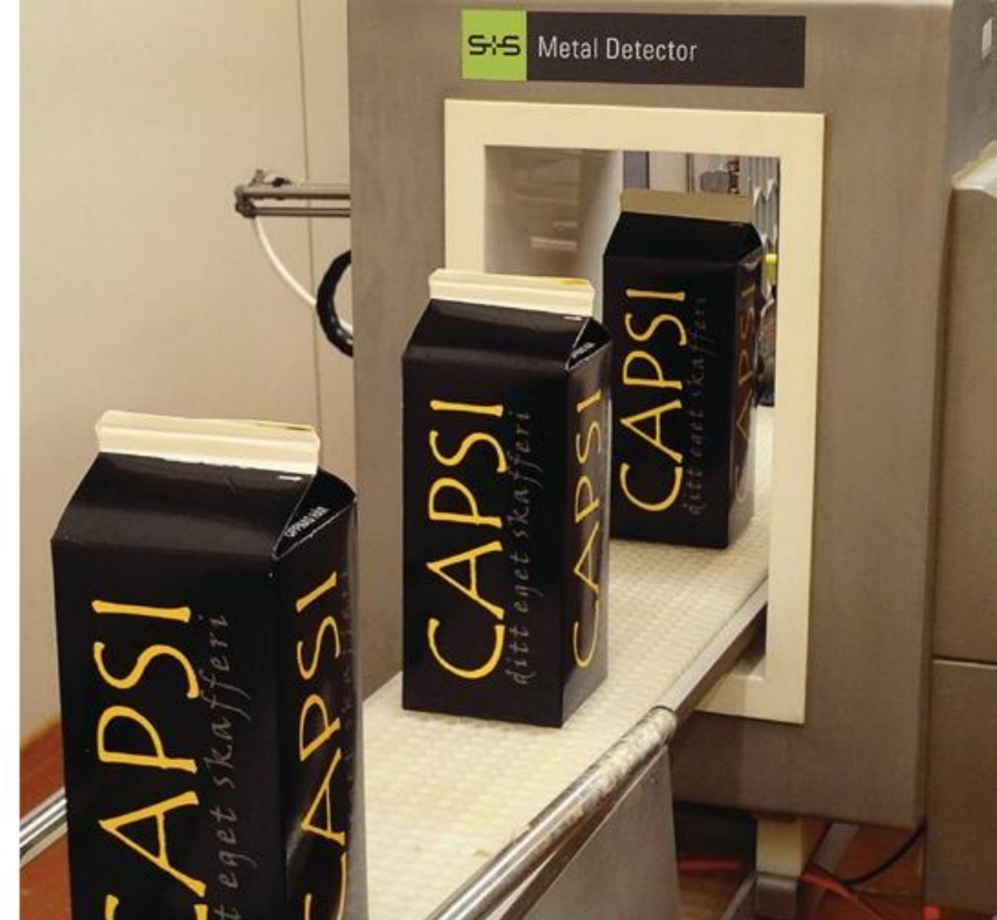
Metalldetektorn spårar om något främman- de kommit in i de färdiga förpackningarna
